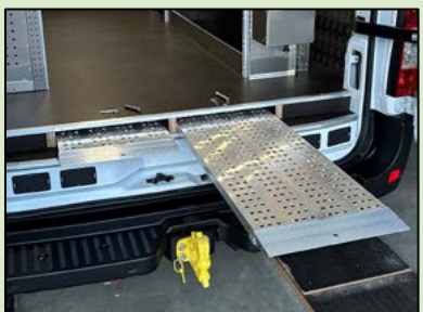
Encastrement de rampe(s) sous plancher
