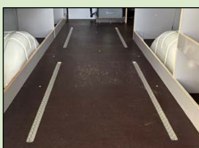
Rails de type aéro bombés ou encastrés avec pions d'arrimage
