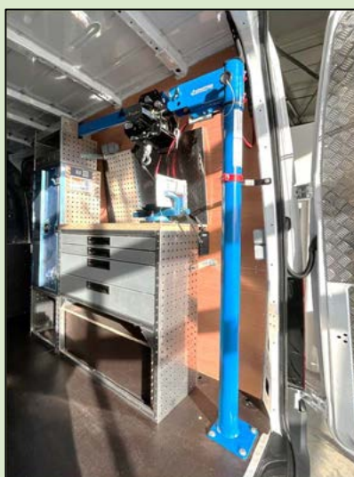
Potence à bras simple ou double avec palan manuel ou électrique
