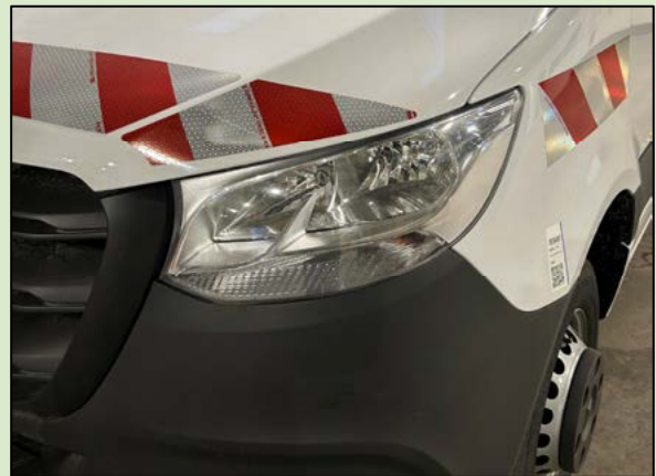
Bandes alternées prismatiques prédécoupées au profil du véhicule
